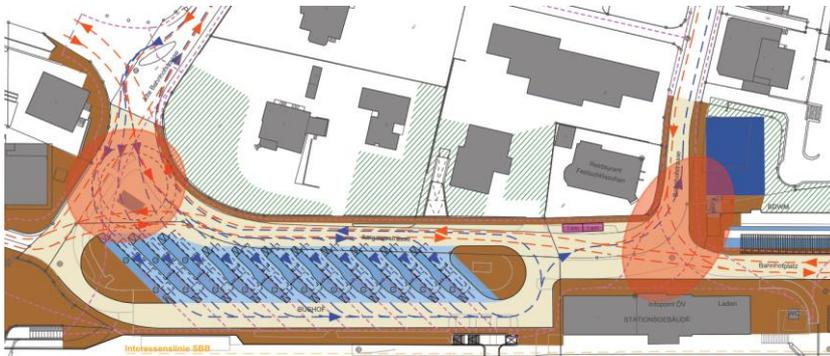
Abb. 6: Layout Bushof mit Analyse Verkehrsströme 27.04.2016
